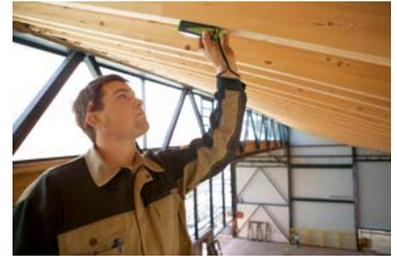
ピタゴラスの定理を使用して距離を計算できます。(ライカ ディストシリーズ A5・A6 にも搭載)
